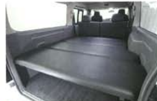
●クッション厚を40mmに設定した専用仕様ベッドキットも登場。5段階の高さ調整機能も備えているので、セカンドシートとつなげて荷室スペースをフルフラットな空間として使用することもできる。表皮は「ベンチングレザー」で各カラーを設定
