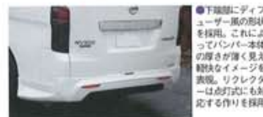
●下部部にディフューザー風の形状を採用。これによってバンパー本体の厚さが薄く見え、軽快なイメージを表現。リフレクターは点灯式にも対応する作りを採用
