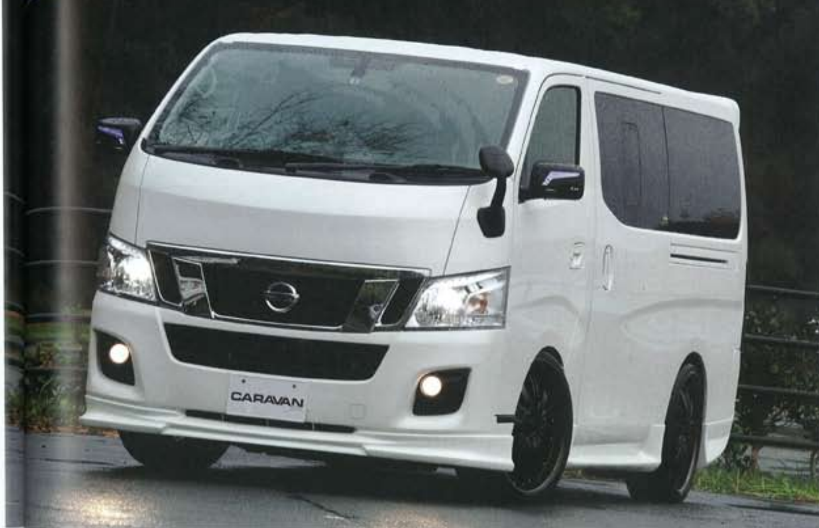
●左右両側部分に「逆V形状」を取り入れ、中央にプレスラインを設ける。これにより開閉感を抑えてローフォルムを生み出すことに成功。もちろん装着時のフィッティング性も抜群
