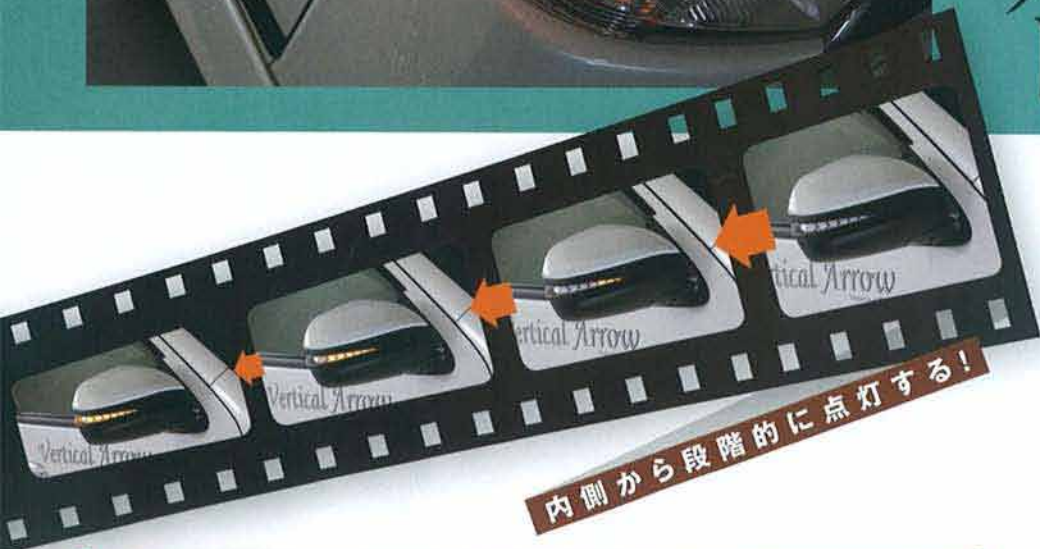
ウインカー点滅時は、レンズ側端の部分まで光り、斜め後方からの視認性も抜群。実用性もしっかりと備えたモデルだ。
