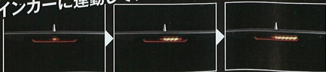
ヴァーティカルアローシリーズに欠かせない、シーケンシャルウインカー機能も採用。ウインカー時は片側へ、ハザード時は両側へとアンバー光が流れる。
