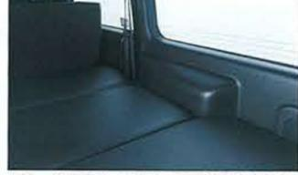
ナロー-S-GLのカーゴスペース専用に設計されている。右側の出っ張りや、シートベルト部など、車両の形状に合わせて作られているのだ。
