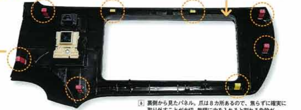
次に上側の「爪」を外す。無理に挟みず、ゆっくりと浮かすように取り外していく。違和感があったらすぐやめるように。
