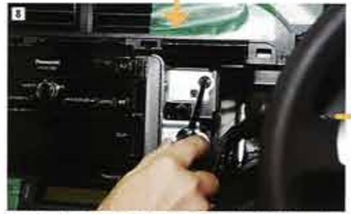
オーディオ/ナビはブラケットを介して取り付けられているので、ブラケットのプラスネジを取り外す。ネジを隙間に落とさないように。
