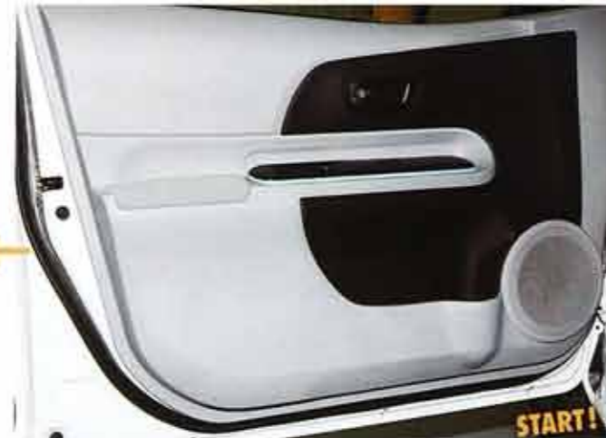
まずはリリースノブの中にある小さなキャップを取り外す。この中にはプラスネジが隠されている。
