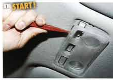
「爪」の位置を確認して、ゆっくりと剥がすように「爪」を取り外す。割れやすいパーツなので注意。
