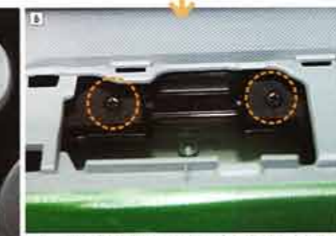
「爪」を全て外したら、パワーウィンドウのコネクターを取り外す。
