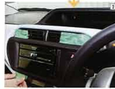
内装に傷が付かないように、ツールを差し込む部分には、糊が残りにくい養生テープを貼っておくといい。
