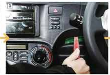
どの部分から外すと言う順番はないが、形状が複雑な右下部分から作業を開始。隙間にツールを差し込み、テコの要領で「爪」を外す。
