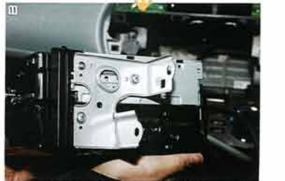
オーディオ/ナビを交換する際には、取り付けブラケットを流用するので、古いユニットから取り外しておく事。
