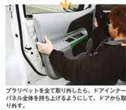
ドアパネルはパネルの外側8カ所をブラリベットで留められている。比較的作業がしやすい下側から、ツールで取り外す。
