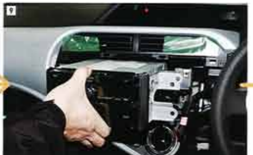
ブラケットを留めているネジ4カ所を取り外せば、あとはユニットを手前に引けばオーディオ/ナビが取り外せる。
