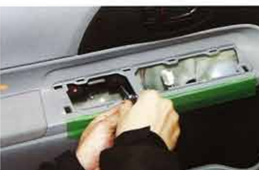
◀▲ハンドル部分を取り外すと、その中にプラスネジが2カ所現れる。これをドライバーで取り外す。こもネジを落としやすいので注意。
