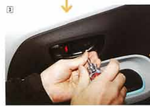
プラスネジを取り外す。このネジを含め、ドアインナーパネルには3カ所しかネジが使われていない。他は全てクリップだ。
