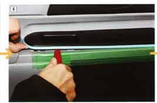
次にドアハンドル部分を取り外す。インナーパネルに傷を付けないように、ツールがあたる部分には養生テープを貼付ける。
