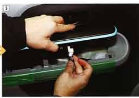
「爪」を全て外したら、パワーウィンドウのコネクターを取り外す。
