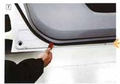
ドアパネルはパネルの外側8カ所をブラリベットで留められている。比較的作業がしやすい下側から、ツールで取り外す。
