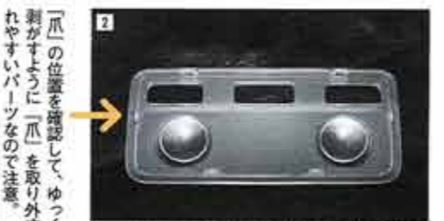
「爪」の位置を確認して、ゆっくりと剥がすように「爪」を取り外す。割れやすいパーツなので注意。
