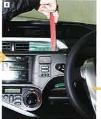
次に上側の「爪」を外す。無理に挟みず、ゆっくりと浮かすように取り外していく。違和感があったらすぐやめるように。
