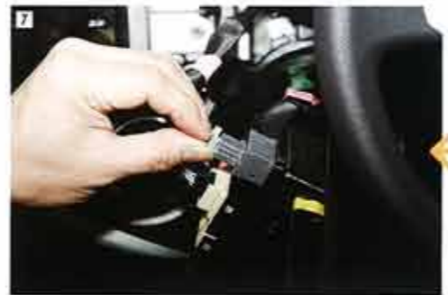
パネルの「爪」が全て外れたら、ハザードランプとディスプレイのスイッチユニットのコネクターを取り外す。
