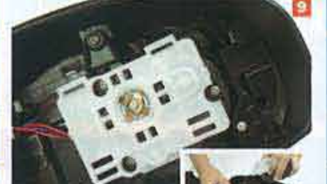
内張り板がしてドアノブのカバーを外し、内張り板を外す。
