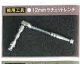
使用工具 ●12mmラチェットレンチ 装着車両 200ハイエース
