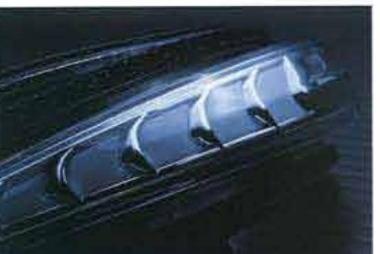
細かい部分の成型で陰影を付けて立体的なシルエットを表現したレンズ内部。点灯する光がよりアピールできる構造になっている。
